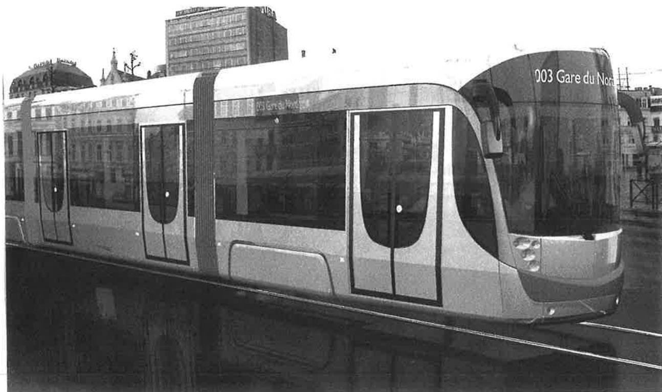
*Photos de la maquette d'une rame Flexity Outlook en version « courte ». La mise en situation est fictive.
